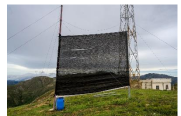
Cleverer Lösung Ein zwischen zwei Stangen gespanntes Plastik-tuch verwandelt Nebel in Kondenswasser. In eineinhalb Stunden sammelt der Nebelfänger 50 Liter, auch in Trockenzeiten.
